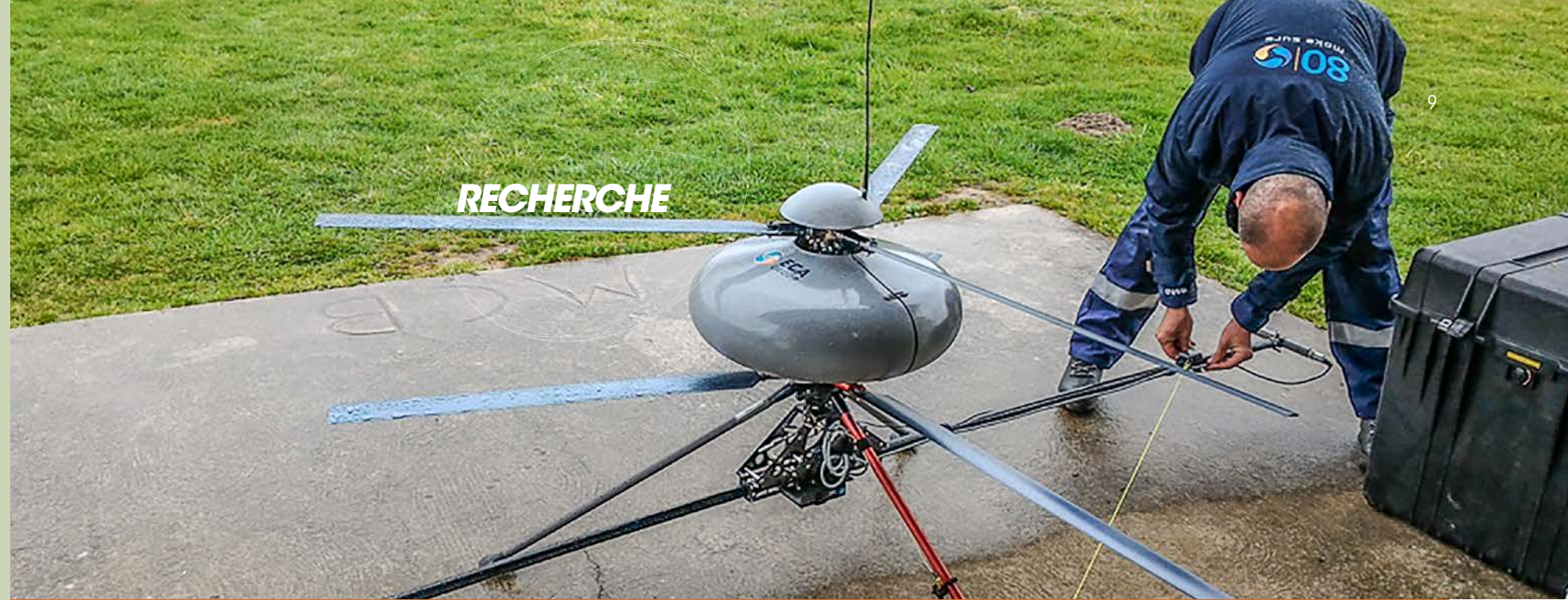
Drone IT-180 en cours d'équipement d'une perche de mesure magnétique. Crédits : Marc Munsch, Paul Calou.
